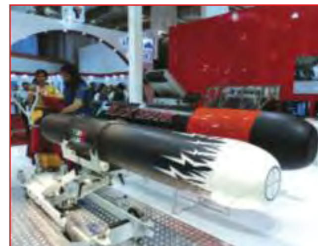
I siluri Flash Black e Black Shark, in fase di acquisizione da parte della Marina Militare Italiana, con il nome di Nuovo Siluro Pesante (NSP). Gli NSP sono destinati a rimpiazzare gli A-184 Modello 3 sui sommergibili classe Todaro.
