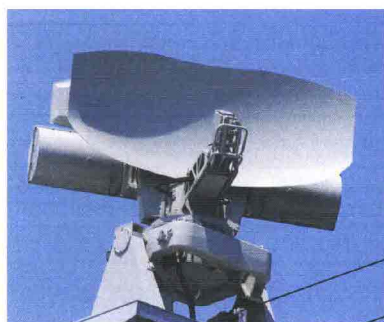
Sotto: un particolare dell'albero poppiero con a destra l'antenna del radar per la correzione di traiettoria in volo del missile del sistema TESEO Mk-2A e del MILAS; a sinistra le 2 antenne dei radar GEM della famiglia MM/SPN-753 (V). (foto: EUP)
