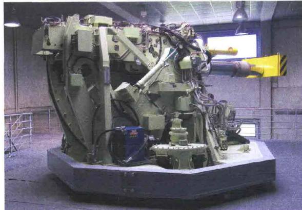
Un 127/64 mm LW VULCANO privo di guscio protettivo utilizzato per scopi didattici. (foto: Oto Melara)
