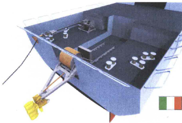
Sopra: la sistemazione del sonar rimorchiato TUS 4249 sulle FREMM ASW. Sopra, a destra: il tamburo con il cavo collegato al trasduttore e il relativo motore.
