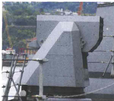
A sinistra: il lanciarazzi polivalente Oto Melara SCLAR-H della fregata BERGAMINI. (foto: EUP). Di lato la vista frontale del medesimo.
