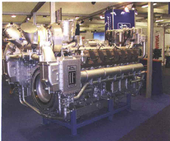
I 4 generatori elettrici sono azionati ciascuno da un diesel common rail Isotta Fraschini VL 1716 HPCR. (foto a sinistra: P. Caiti - immagine a destra: Isotta Fraschini)
