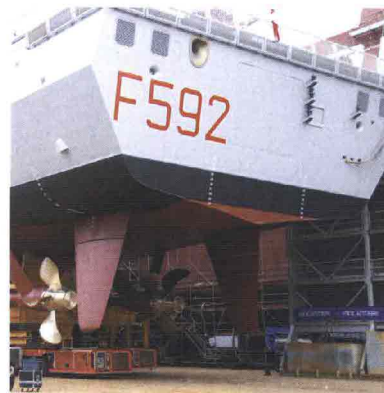
A sinistra: i timoni dotati di sistema di stabilizzazione "Rudder-Roll" e le eliche Fincantieri della fregata FASAN prima dell'allungamento. A destra: la fregata MARGOTTINI dopo l'allungamento. (foto: EUP)
