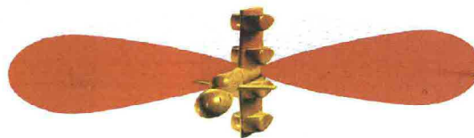
A sinistra: il trasduttore ("pesce") del sonar rimorchiato TUS 4249. Sotto: una vista trasparente del suddetto trasduttore con i 4 elementi piezoelettrici. Sopra: l'involuppo delle emissioni di tale trasduttore.
