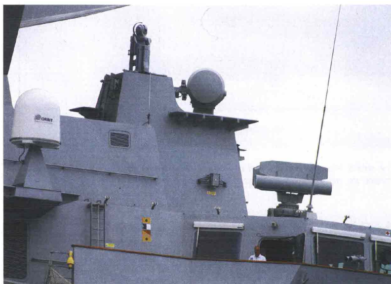
Sopra: i 3 sensori di SELEX ES presenti sopra/dietro la plancia. A partire da destra: l'antenna del radar RASS (MM/SPS-791), quella dell'RTN-25X e la testa del sistema elettro-ottico SASS. Sotto: l'antenna del radar RASS MM/SPS-791. (foto: EUP)
