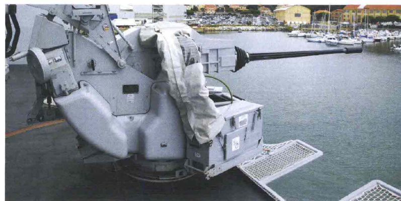
Sopra: il complesso Oto Melara Mod. 503 impiegante la mitragliera Oerlikon da 25/80 mm in azione. Sotto: una delle 2 armi da 25/80 mm della fregata BERGAMINI. (foto: EUP)
