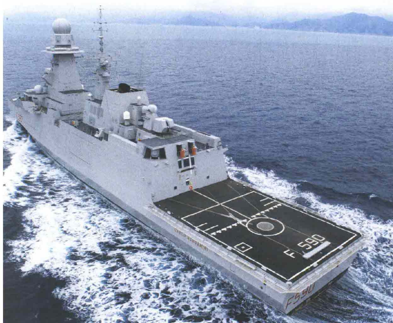
Il ponte di volo delle FREMM ha una superficie di 565 m 2 . (foto MM)
