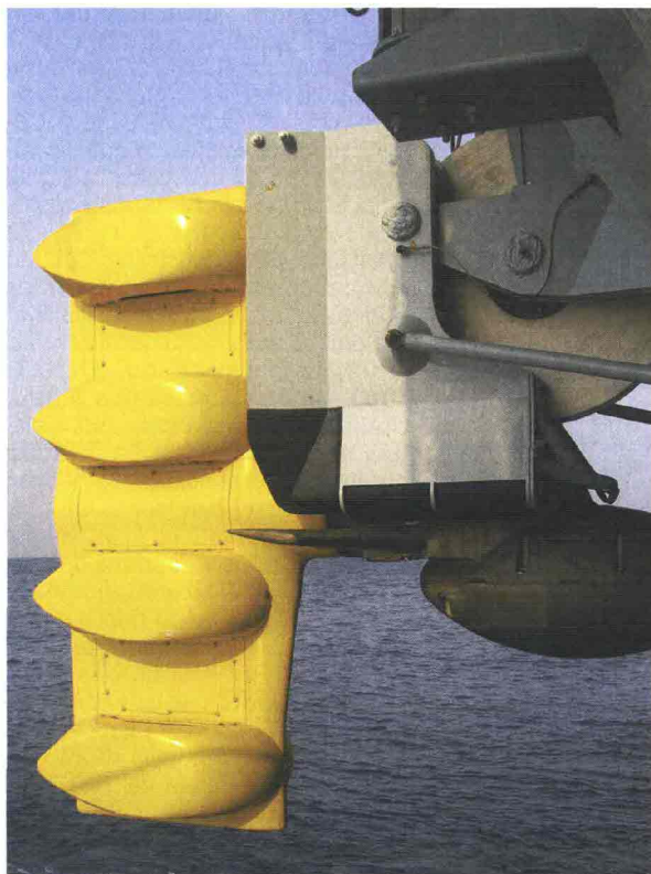
A sinistra: il trasduttore ("pesce") del sonar rimorchiato TUS 4249. Sotto: una vista trasparente del suddetto trasduttore con i 4 elementi piezoelettrici. Sopra: l'involuppo delle emissioni di tale trasduttore.
