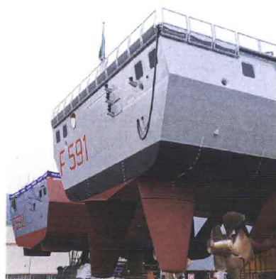
A sinistra: i timoni dotati di sistema di stabilizzazione "Rudder-Roll" e le eliche Fincantieri della fregata FASAN prima dell'allungamento. A destra: la fregata MARGOTTINI dopo l'allungamento. (foto: EUP)
