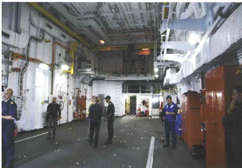
L'interno dell'hangar di dritta, quello di maggiori dimensioni, dotato di carro ponte per la manutenzione degli elicotteri. (foto: EUP)
