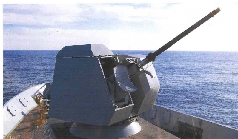
Sopra: la torre Oto Melara da 76/62 mm DF (impiegante il sistema DAVIDE/STRALES) della fregata MARGOTTINI. Di lato è visibile il relativo radar di tiro SELEX ES RTN-25X. Sotto è ritratta la torre pronta al tiro con munizionamento guidato DART. (foto: Oto Melara)
