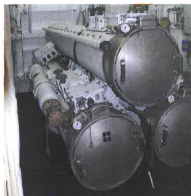
Uno dei 2 lanciasiluri trinati WASS B-515 da 324 mm presenti sulle FREMM. (foto: EUP)
