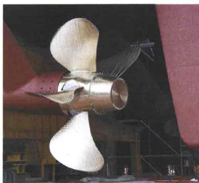
Sopra: l'elica Fincantieri a passo variabile e reversibile. (foto: EUP) Sotto: la turbina a gas (TAG) LM-2500+G4. (foto: G. E.)
