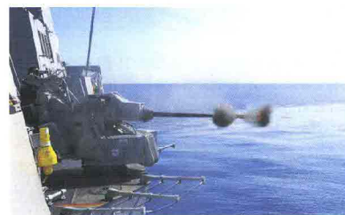
Sopra: il complesso Oto Melara Mod. 503 impiegante la mitragliera Oerlikon da 25/80 mm in azione. Sotto: una delle 2 armi da 25/80 mm della fregata BERGAMINI. (foto: EUP)
