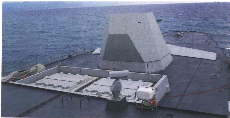
Vista della zona prodiera della fregata BERGAMINI. Dietro la torre da 127/64 mm si vedono i portelli dei pozzi di lancio del sistema SYLVER A50. (foto: EUP)
