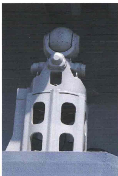
Il sistema elettro-ottico bispettrale SELEX ES SASS con la sua struttura di supporto.
