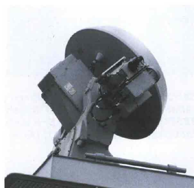
Sopra: il radar di tiro RTN-25X della fregata MARGOTTINI. (foto: EUP) Sotto: la testa del sistema elettro-ottico SASS. (foto: SELEX)
