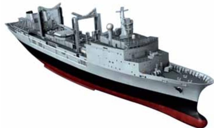
**Unità Rifornitrici (AOR).** Utilizzate per il trasporto e rifornimento in mare di combustibili, lubrificanti, munizionamento, viveri, medicinali e di altri materiali di supporto. Sono dotate di diverse stazioni di rifornimento e di ponte di volo capace di operare con elicotteri medio-pesanti e leggeri, sia nazionali sia di Marine alleate, con possibilità di ricovero in hangar di un elicottero.
