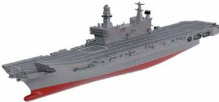
**Portaerei (CVH).** Possono imbarcare un gruppo di volo misto, aerei ed elicotteri, composto da circa 20 aeromobili. Gli aerei impiegati sono gli AV8B, a decollo corto e atterraggio verticale e gli F35B, con compiti di protezione aerea della flotta e supporto ravvicinato alle operazioni anfibe e terrestri. Gli elicotteri sono tutti quelli in linea attualmente in Marina, in particolare i nuovi EH101 e SH90.
