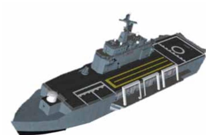
**Navi Anfibia (LPD).** Sono navi da sbarco con ponte di volo continuo da cui possono operare fino a un massimo di quattro elicotteri. Inoltre la nave possiede le caratteristiche ro-ro per l'imbarco e sbarco veicoli e può operare sia in punti attrezzati sia in acque prospicienti spiagge aperte.
