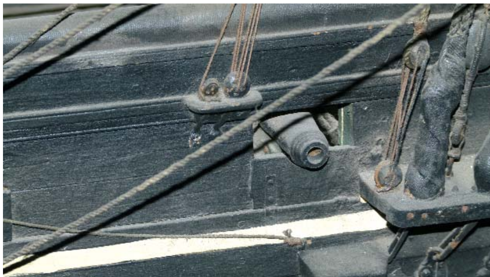
Fig. 5. Dettaglio della volata e della bocca di una carronata del ponte di coperta.
