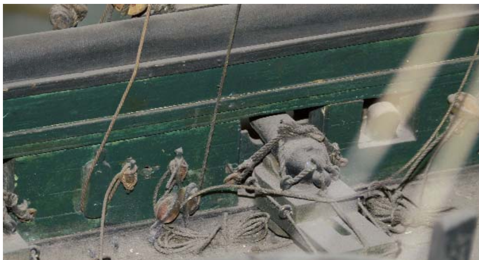
Fig. 6. Carronata del ponte di coperta. Si noti in particolare il grado di dettaglio con il quale sono stati riprodotti il caratteristico affusto a slitta e la trincatura del pezzo a murata.
