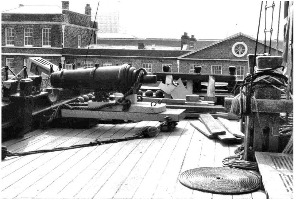
Fig. 7. Carronata da 68 libbre su affusto a slitta sul castello del vascello di linea britannico HMS Victory . (Fotografia dell'autore)
