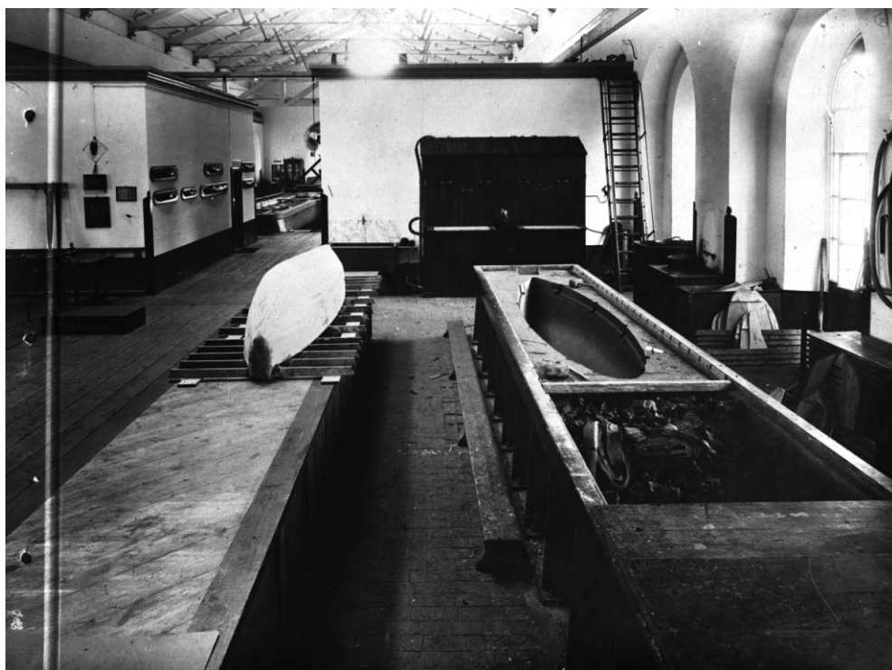
L'officina per la costruzione dei modelli di carena della vasca navale della Spezia; in particolare si nota lo stampo impiegato per la fusione dei modelli in paraffina. (Fonte: Marina Militare)
