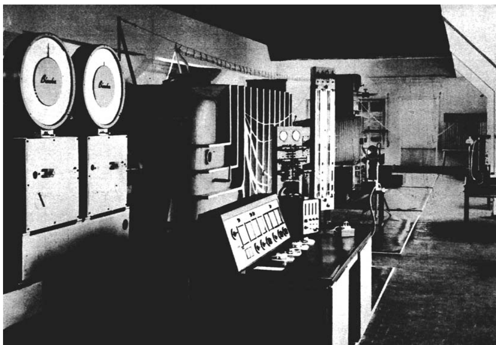
Immagine della strumentazione di comando e rilievo dati del tunnel di cavitazione del Centro per Esperienze Idrodinamiche della Marina Militare nel 1963. (Fonte: Marina Militare)
