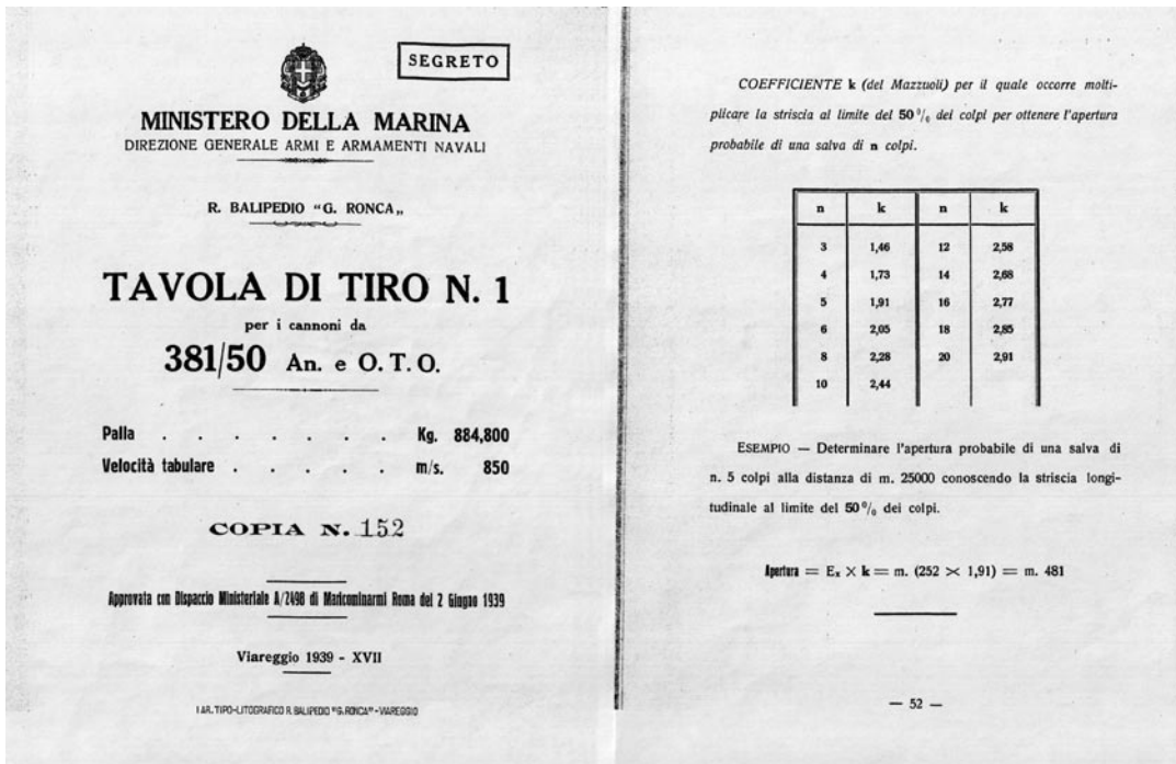
Fig. 11 – Frontespizio delle Tavola di Tiro n° 1 per cannone da 381/50 e metodo di calcolo (pag. 25) della “Apertura probabile” basato sui valori del “ k del Mazzuoli” e su quelli della “Striscia al 50 % longitudinale” (grandezza indicata con il simbolo E x ). Anche in questo documento il nome del Mazzuoli compare solo tra parentesi. Da notare l’elevato peso del proietto “Palla” sparato dal cannone in oggetto ( Tavola di Tiro n° 1 per cannoni da 381/50 Ansaldo mod. 1934 – OTO mod. 1935 e Palla da 884,8 Kg sparata a 1 a carica, Regio Balipedio Gregorio Ronca, 1939)
