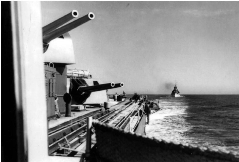
Fig. 8 – Le torri binate poppiere da 152/53 dell'Incrociatore Emanuele Filiberto Duca d'Aosta , della classe omonima. In primo piano le ferroguidate per la posa di mine ancorate (Arch. USMM, Fondo Fraccaroli)
