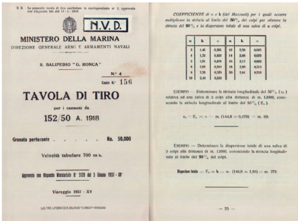
Fig. 3 – Frontespizio della Tabola di tiro n° 4 per cannone da 152/50 e calcolo della “Apertura probabile” basato sul metodo del Mazzuoli e sui valori della “Striscia al 50 % longitudinale” (grandezza indicata con il simbolo E_x ). Da notare che in questo documento il nome del Mazzuoli compare solo tra parentesi (Tabola di Tiro n° 4 per cannoni da 152/50 Armstrong 1918 e Granata Perforante da 50 Kg sparata a 1 a carica, Regio Balipedio Gregorio Ronca, 1937, pag. 25)
