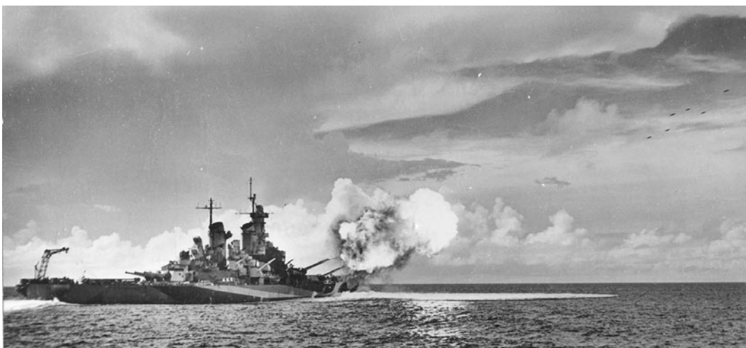
Fig. 17 – La Nave da battaglia USS Missouri (BB-63) spara una salva di sei colpi da 406/50 con le sue due torri di prora (1944). I sei proiettili in volo sono ben visibili in alto, sul lato destro dell'immagine. Sebbene i colpi siano stati sparati nello stesso istante da armi tra loro uguali (probabilmente sottoposte allo stesso livello di manutenzione), è già possibile apprezzare l'esistenza tra essi di un certo distanziamento longitudinale, cui corrisponderà una certa distribuzione (cioè una certa dispersione) dei loro punti di caduta (U.S. Navy Photograph 80-G-47815, National Archives, via Naval History and Heritage Command )
