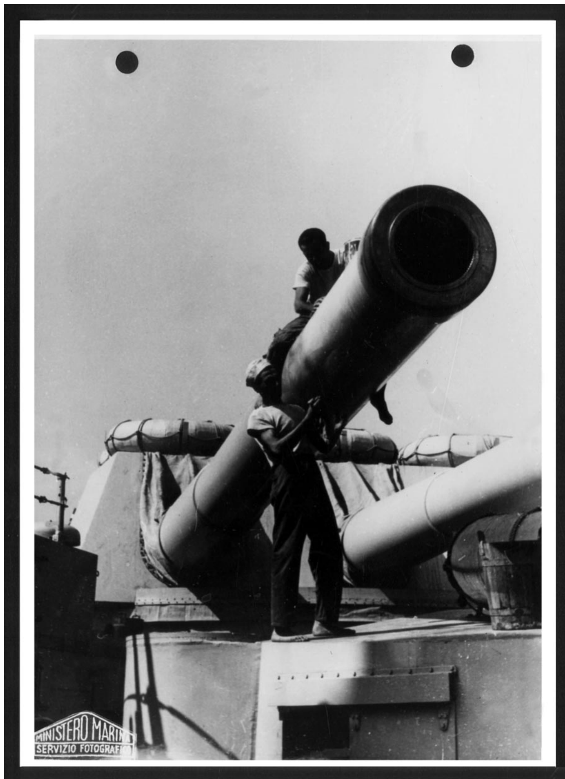
Fig. 13 – Torre poppiera da 381/50 di una Nave da battaglia classe “Vittorio Veneto”, pulizia della zona di volata della bocca da fuoco di dritta, forse dopo una serie di tiro (Arch. USMM)
