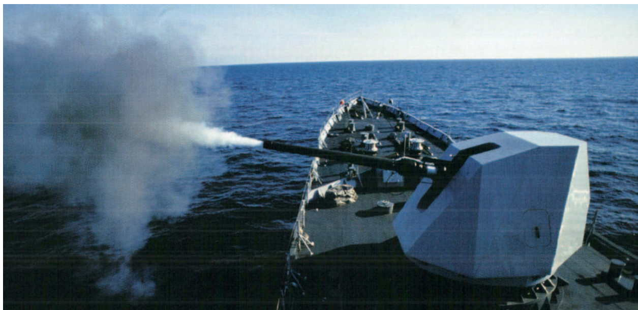
Fig. 15 – Cannone da 127/54 Low Weight (LW) OTO-Melara mentre spara una serie di colpi dalla Fregata Bersagliere in navigazione, primi anni 2000 (OTO-Melara)
