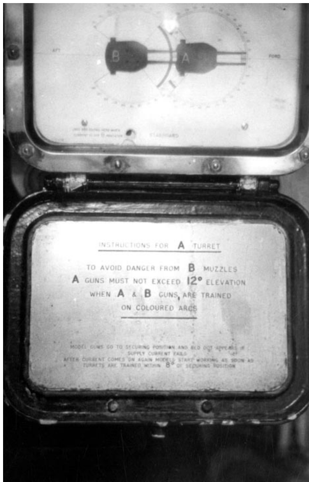
Fig. 28 – Creta, baia di Suda, incrociatore britannico York . “Congegno esistente nella stazione D.T. autonoma della torre poppiera. Serve ad evitare danni alla torre B, per effetto della torre A quando fa tiro autonomo”, 28 maggio – 3 giugno 1941 (AUSMM, fondo Mezzi d'assalto , b. F, fasc. 6, sfasc. 1)
