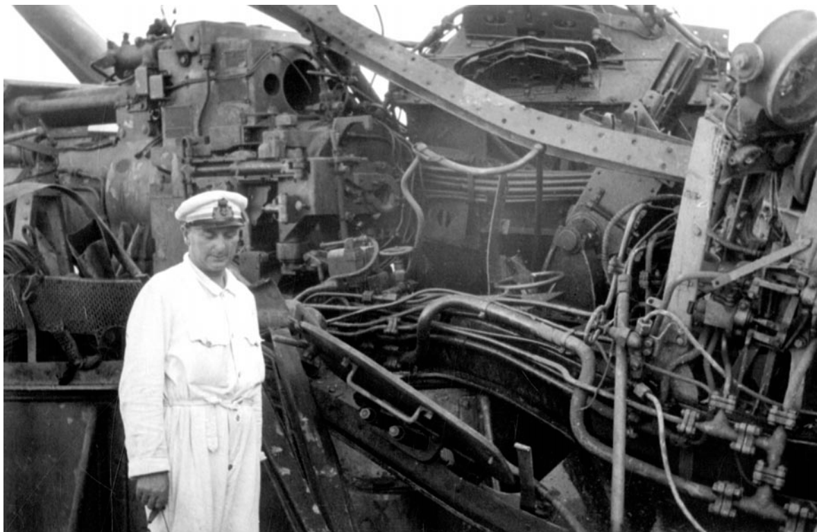
Fig. 23 – Creta, baia di Suda, incrociatore britannico York. Dettaglio dei danni causati da una bomba tedesca alla torre popoiera, 28 maggio – 3 giugno 1941 (AUSMM, fondo Mezzi d'assalto, b. F, fasc. 6, sfasc. 1)
