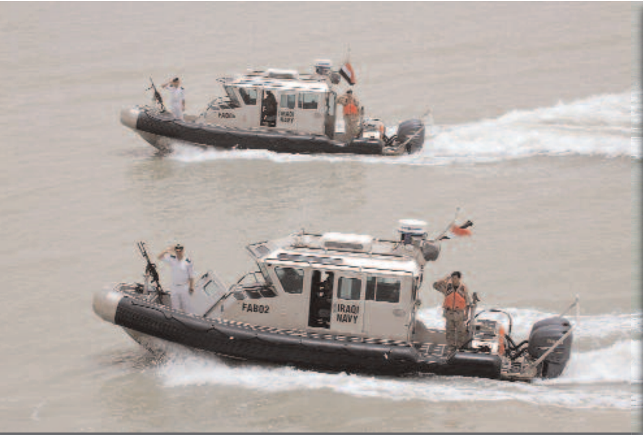
la Marina irachena schiera 26 Fast Attack Boat «Defender», che si differenziano dal modello per la Guardia Costiera americana per l'impianto propulsivo fuoribordo e un sistema di condizionamento potenziato (US DoD).
