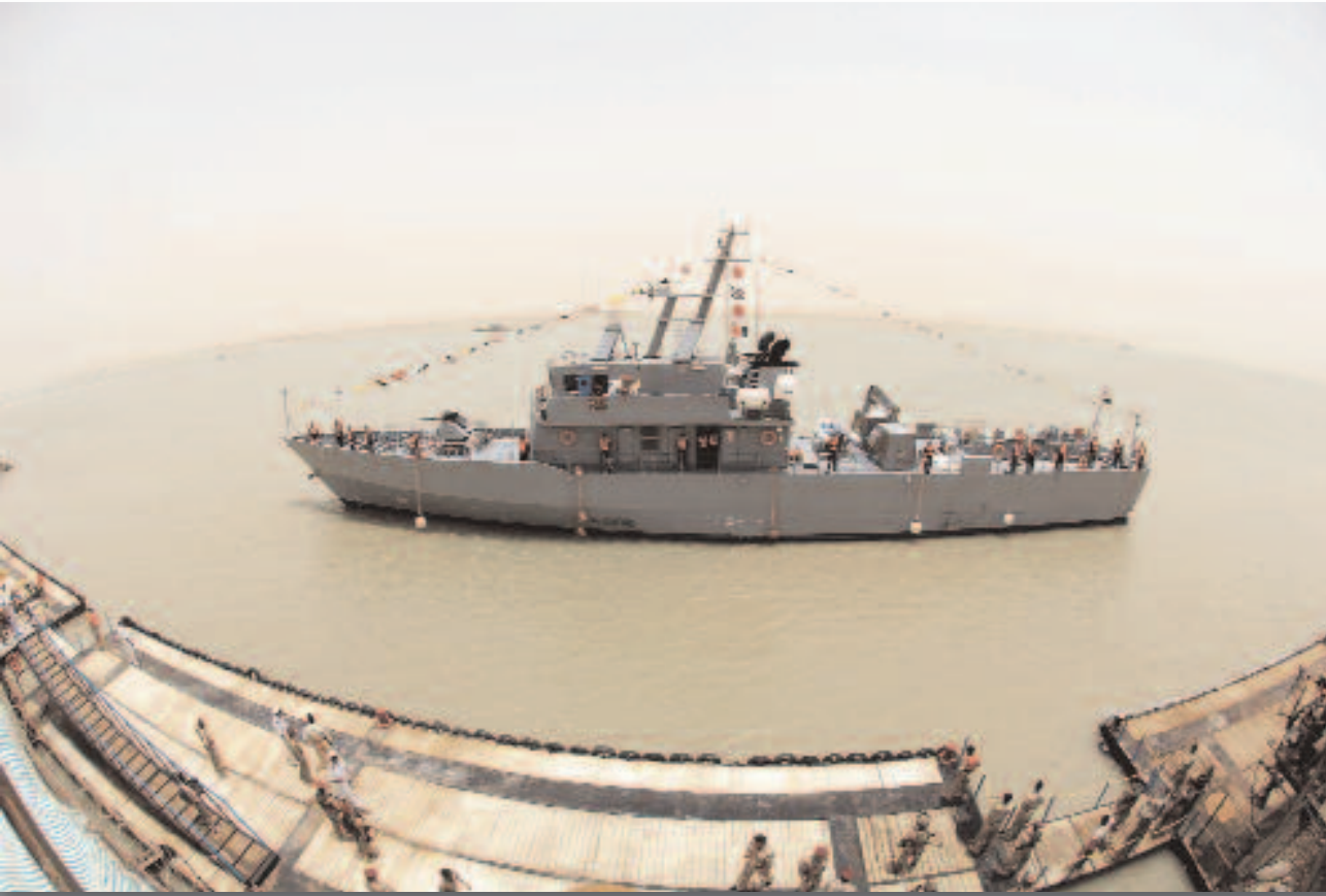
Le unità classe «Fateh» sono in grado di lanciare e recuperare da postazione poppiera un RHIB da 7 m con un team ispettivo per il controllo del traffico commerciale (US DoD).
