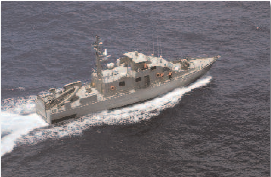
La prima unità (P-301) del tipo CPB da 35 metri, dotata d'impianto propulsivo convenzionale e suite integrata di conduzione, comando e controllo dell'armamento, è divenuta operativa nel gennaio 2011. Le unità di questa classe rappresenteranno la spina dorsale della Marina irachena insieme ai quattro OPV tipo «Saettia Mk4» (US DoD).
