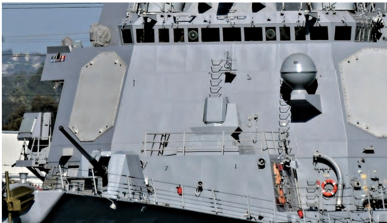
Un primo piano del sistema laser ODIN, concepito per contrastare i velivoli a pilotaggio remoto e installato sulla tuga anteriore alla plancia del cacciatorpediniere lanciamissili DEWEY (Fonte: US Navy ).
