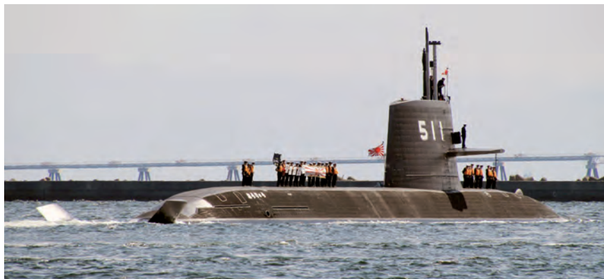
Il sottomarino giapponese ŌRYŪ ripreso dopo l'ingresso in linea: si tratta dell'undicesimo esemplare della classe «Soryu» e primo battello al mondo a essere dotato di una batteria agli ioni di litio (Fonte: MHI).
