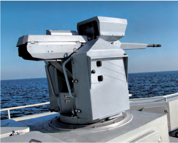
Una torretta a controllo remoto Narwhal 2B da 20 mm a bordo di un'unità della Marina francese e oggetto di ammodernamento a cura della società Nexter (Fonte: Nexter).
