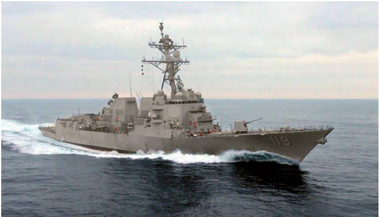
Il cacciatorpediniere lanciamissili DELBERT D. BLACK , ripreso nel corso delle prove iniziali a carico della società costruttrice, condotte nel Golfo del Messico. L'unità appartiene alla classe «Arleigh Burke» in configurazione «Flight IIA» (Fonte: US Navy ).
