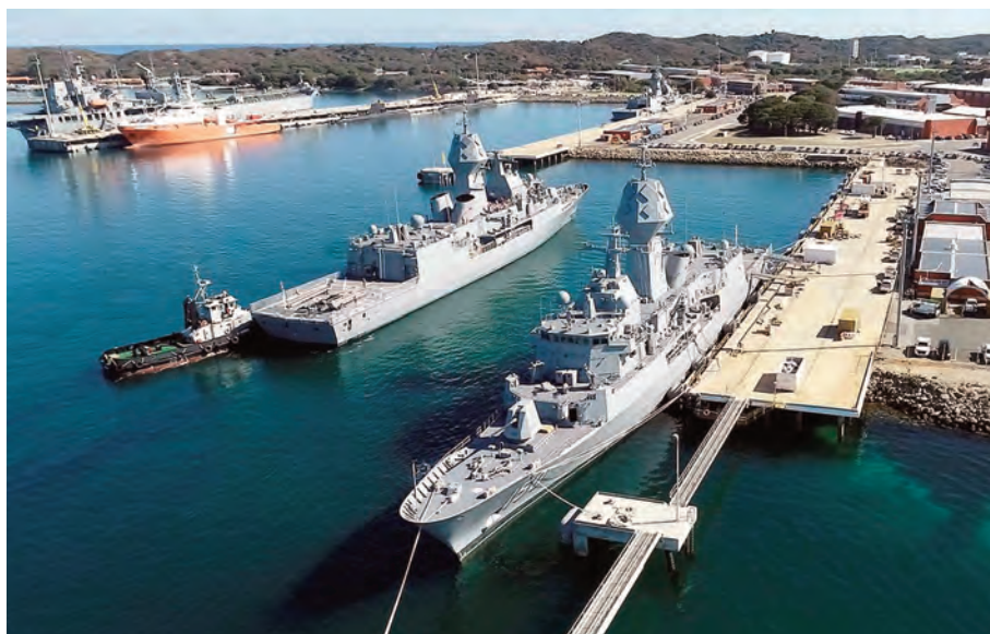
Le fregate ANZAC ed ARUNTA equipaggiate con il nuovo albero troncopiramidale quale parte del programma di ammodernamento AMCAP in corso di installazione anche sul WARRAMUNGA (Fonte: Royal Australian Navy).
