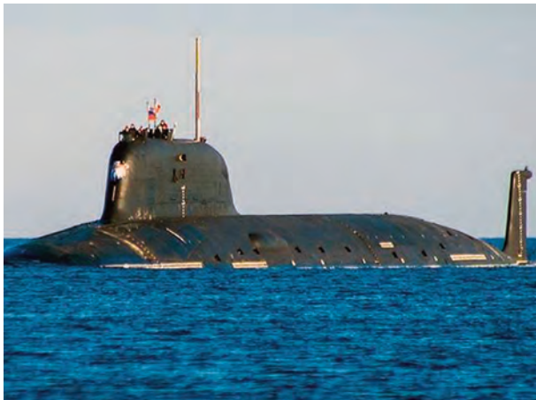
Il sottomarino nucleare d'attacco e lanciamissili da crociera KAZAN, appartenente alla classe «Yasen-M/Project 885M» ed equipaggiato con i missili ipersonici «Tsirkon» (oggetto di prove particolari), con gli ordigni da crociera della famiglia «Kalibr» e con i missili antinave «Onyx» (Fonte: TASS).
