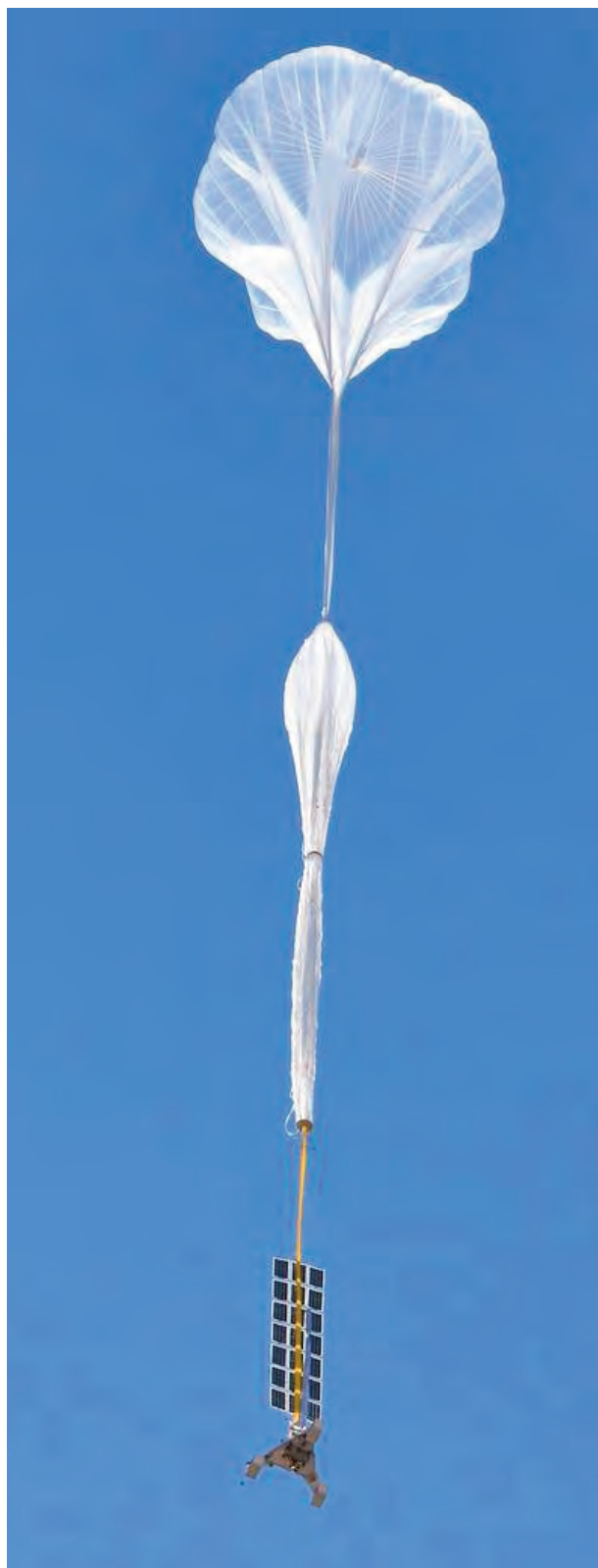
Esempio di pallone stratosferico. Il World View Stratollite costituito da pallone principale e secondario, pannello solare e payload (Fonte: nasa.gov/image-feature/world-view-stratollite-test ).
