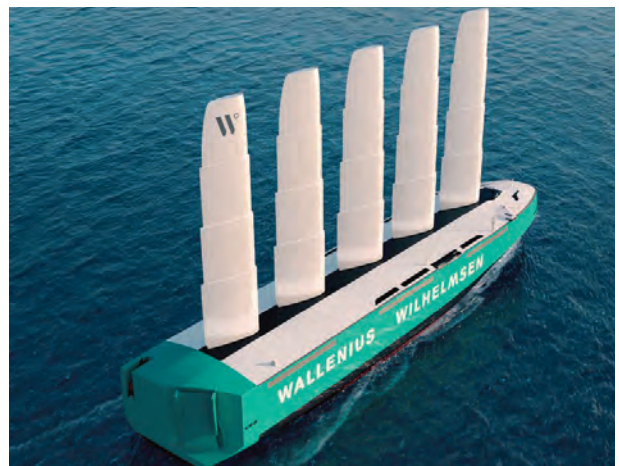
Figura 9 (b). Orcelle wind, RoRo ship; concept di Wallenius Wilhelmsen con Oceanbird [6].
