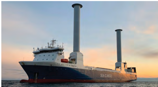
Figura 11b. SC CONNECTOR, sea-cargo; installazione di 2 Rotor Sail Norsepower Gennaio 2021. Riduzione di emissioni stimata -25% [8]
