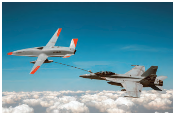
Rifornimento in volo fra un MQ-25A «Stingray» a controllo remoto e un velivolo da combattimento F/A-18 «Super Hornet» dell'US Navy (Boeing).
