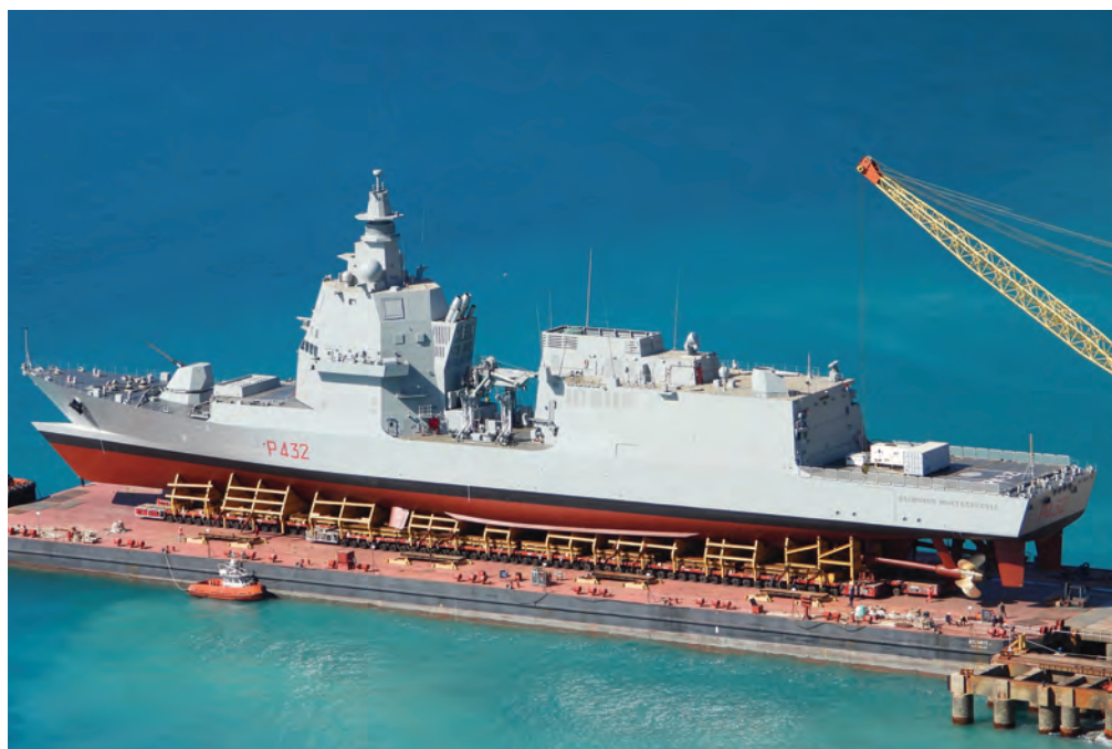
Varo tecnico del terzo Pattugliatore Polivalente d'Altura (PPA), intitolato al generale, politico e scrittore Raimondo Montecuccoli presso il cantiere Fincantieri di Riva Trigoso (Autore).
