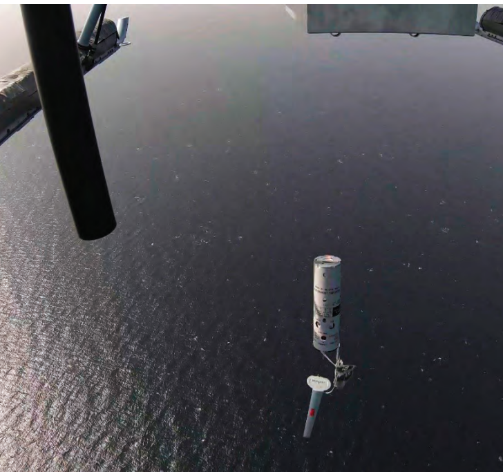
Le società Northrop Grumman e Ultra Electronics hanno dimostrato che, grazie a un'apposita suite, il velivolo senza pilota «MQ-8C Fire Scout» in servizio con l'US Navy può portare a termine missioni ASW in modo completamente automatico (Northrop Grumman).
