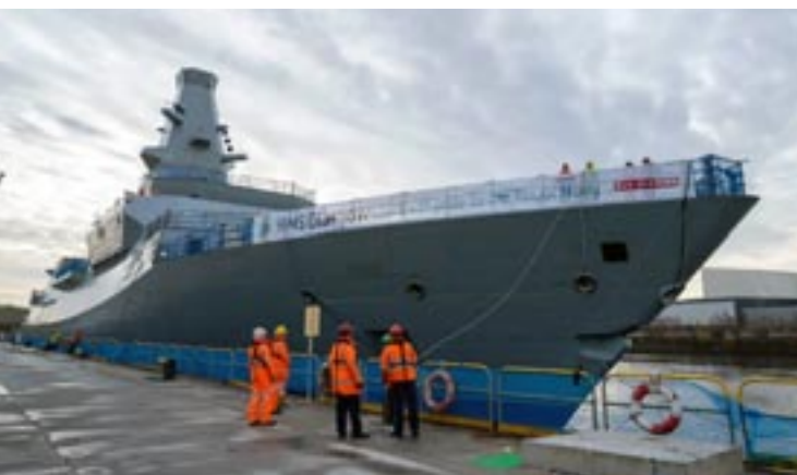
La fregata GLASGOW , ripresa all'ormeggio alla banchina d'allestimento del cantiere BAE Systems di Scotstoun: l'unità è stata messa a galleggiare in acque profonde, dopo un laborioso processo di movimentazione dal cantiere di costruzione (a Govan) alla banchina d'allestimento (Foto BAES).
