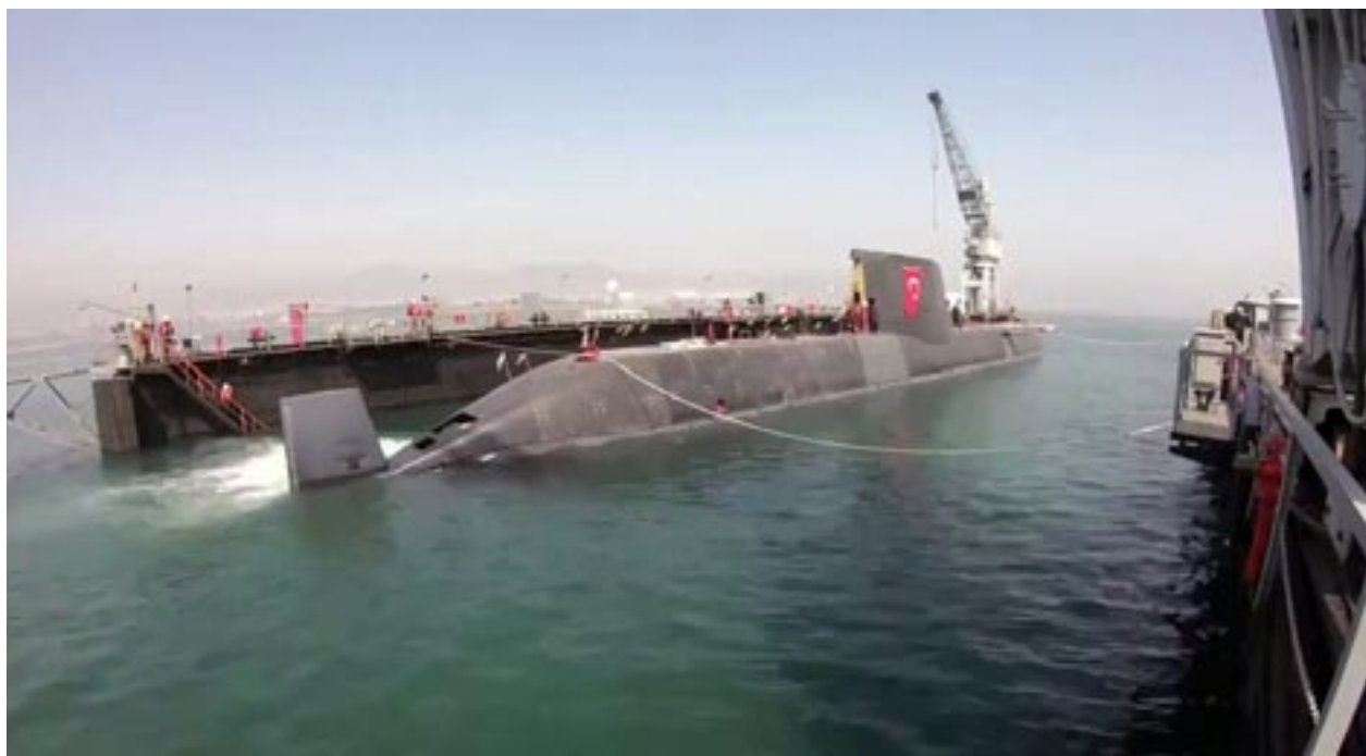
Il varo del sottomarino turco PIRI REIS , eponimo di una classe di sei battelli di nuova generazione, derivati da un progetto tedesco, caratterizzati da un impianto AIP ed equipaggiati con numerosi sistemi e sensori sviluppati dall'industria della difesa turca (Turkish MoD).
