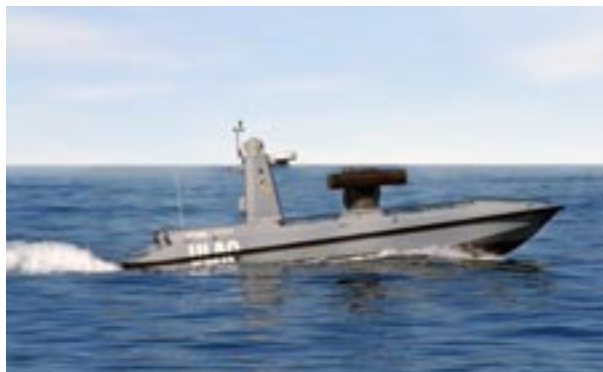
Primo piano dell'Ulaq, primo mezzo navale di superficie da combattimento a controllo remoto prodotto in Turchia e armato con missili a guida laser: testato in mare dal vivo nel 2021, l'Ulaq è stato citato dalla stampa specializzata turca quale primo esemplare al modo di mezzo di superficie a controllo remoto armato e operativo (ARES).
