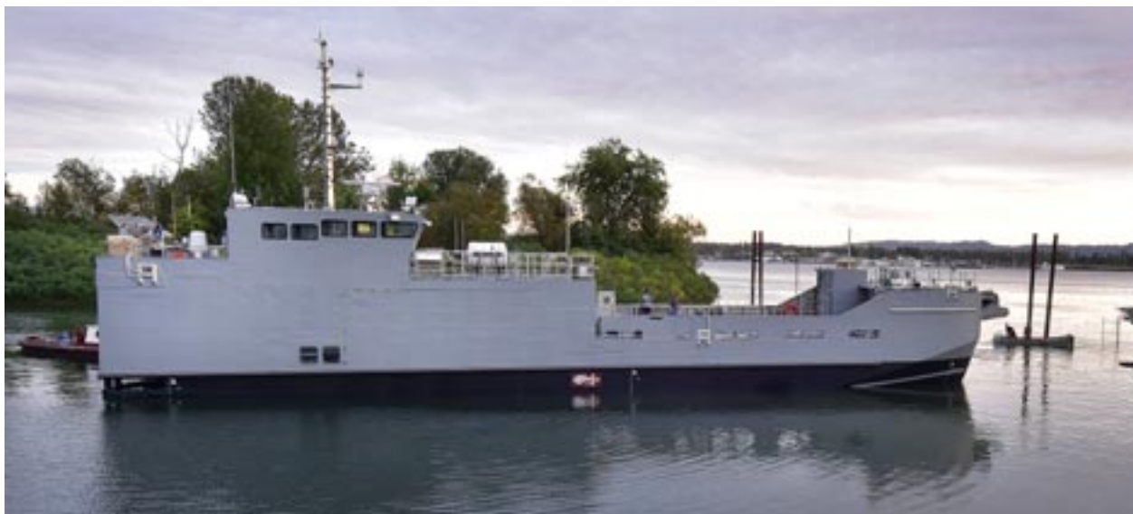
Il prototipo della nuova unità navale di supporto alla manovra per l'US Army o MSV(L) (Maneuver Support Vessel) (Light), è stato varato il 10 ottobre presso il sito navale della società Vigor a Vancouver (Washington). L'MSV (L) sostituirà l'LCM-8 (Landing Craft Mechanized-8), un'imbarcazione dell'epoca della Guerra del Vietnam che non è in grado di trasportare parte dell'equipaggiamento odierno a causa del peso dei moderni veicoli da combattimento (US Army).
