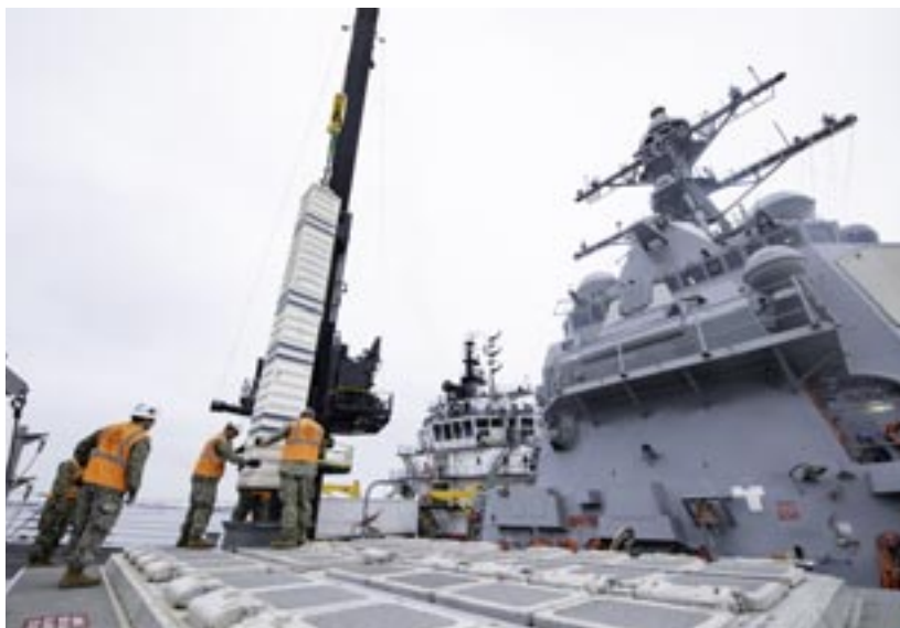
Con un'attività svoltasi presso la base navale di San Diego, la US Navy ha testato e dimostrato la capacità di rifornimento armi del sistema di lancio verticale «Mk 41» a bordo del caccia lanciamissili SPRUANCE (DDG 111) grazie al trasferimento dalla nave da supporto offshore MV OCEAN VALOR del MSC (Military Sealift Command) (US Navy).
