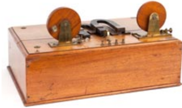
Detector Marconi utilizzato nella campagna sperimentale a bordo della Carlo Alberto nell'estate del 1902. Esposto al Museo nazionale della scienza e della tecnologia Leonardo da Vinci di Milano (wikipedia.org).
