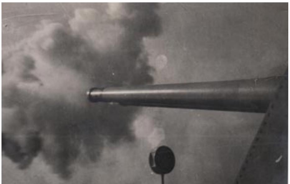
Un complesso binato da 120/50 di un esploratore leggero della classe "Navigatori". Quell'impianto fu molto criticato e venne sostituito, tra il 1938 e il 1940, dai modelli 1931 unificati, sia pur mantenendo lo scudo originario. (Collezione Enrico Cernuschi)
