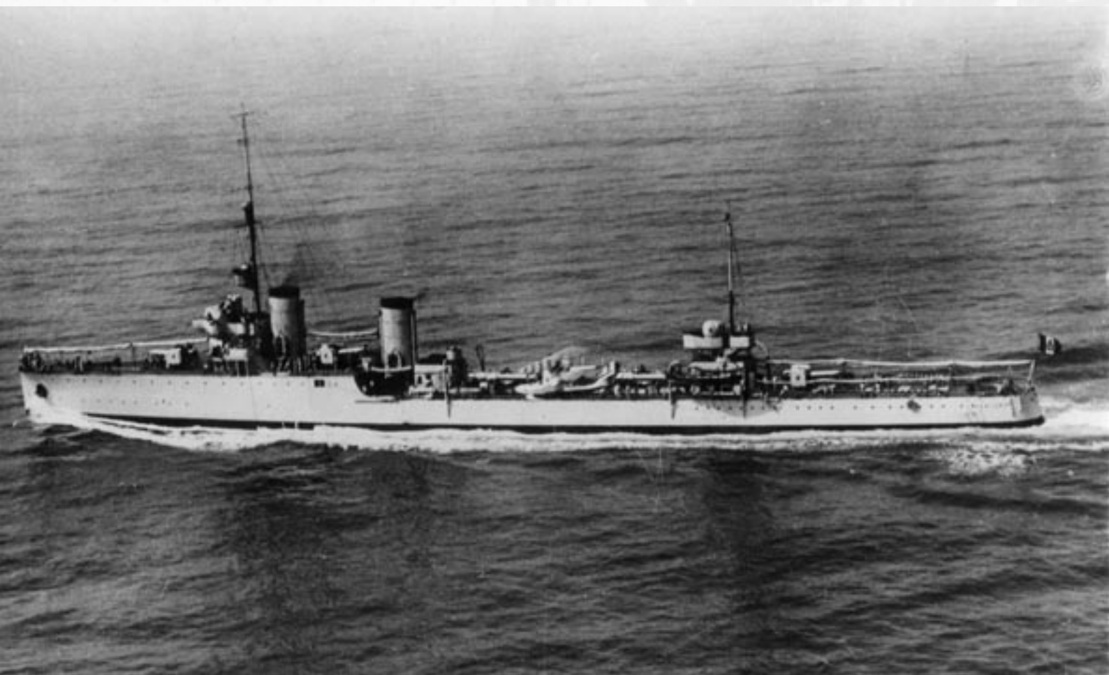
Il cacciatorpediniere Pantera . Queste grosse, ma ormai anziane siluranti non erano in grado di sviluppare, nel 1940, più di 28 nodi né la loro mancanza di protezione avrebbe permesso di affrontare, di giorno, gli incrociatori avversari.
