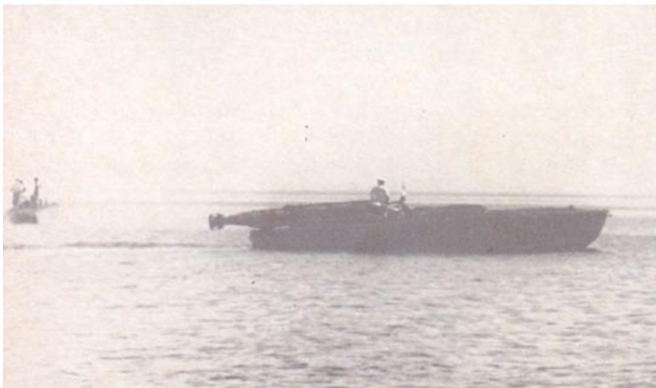
Assab, primavera 1941. Un motoscafo GIS per inseguimento siluri armato con un'arma da 450 mm che poteva essere lanciata da uno scivolo. ( Rivista Marittima )
