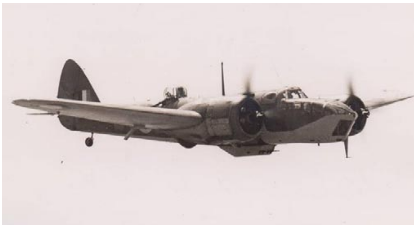
Un caccia pesante bimotore Blenheim MK IV F. Notare le 4 mitragliatrici da 7,7 mm sotto il ventre. (Collezione Ludovico Slongo)
