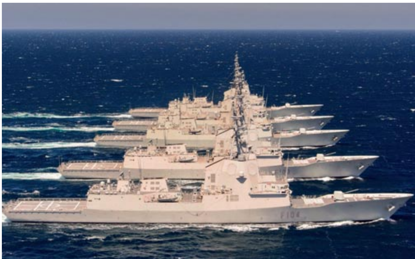
Le 5 fregate antiaeree spagnole classe "Álvaro de Bazán", 4 delle quali consegnate nel 2002-06, seguite nel 2012 dal CRI-STÓBAL COLÓN , versione migliorata con nuovi diesel e una versione più avanzata del radar SPY-1D mutuato dal sistema AEGIS (Navantia)
