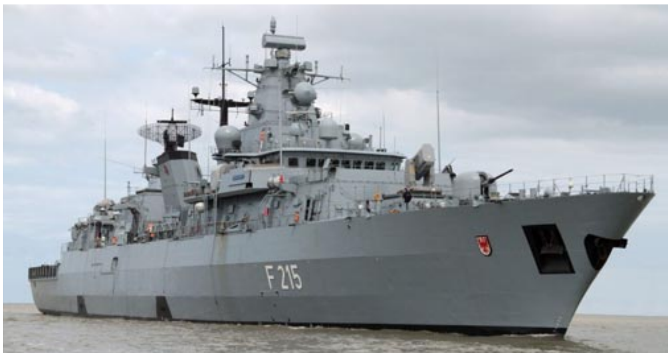
La fregata tedesca BRANDENBURG , capoclasse di 4 FFG tipo F-123 costruite nel 1989-96 sulla base di un progetto MEKO, in fase di ammodernamento (Bundeswehr).
