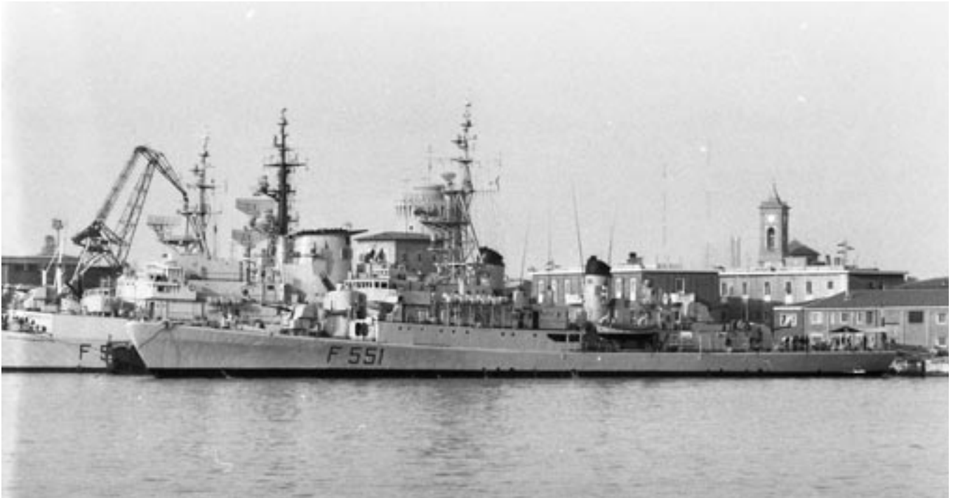
La fregata CANOPO, una delle 4 unità classe "Centauro" realizzate nel 1952-58, ripresa dopo l'ammodernamento con i nuovi cannoni da 76/62 mm di OTO-Melara (Wikipedia).
