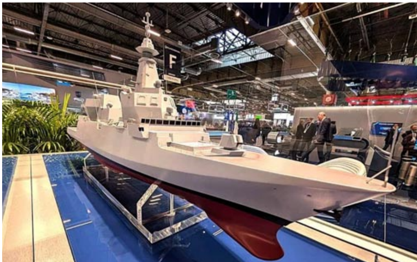
Modello della nuova FREMM-EVO, in costruzione dal 2025 per la Marina italiana in 2 esemplari ASW da consegnare nel 2029-30: è contraddistinta da nuovi radar a facce planari e da una dotazione missilistica raddoppiata (OCCAR).
