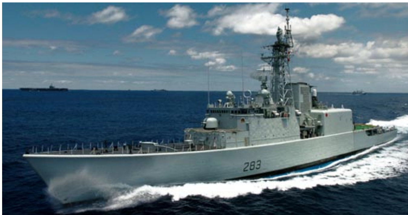
Il DDG canadese ALGONQUIN , una della 4 unità classe “Iroquois” costruite nel 1968-73, qui nella versione ammodernata col programma TRUMP del 1987-95, con VLS Mk-41 per missili “Standard” (US Navy).
