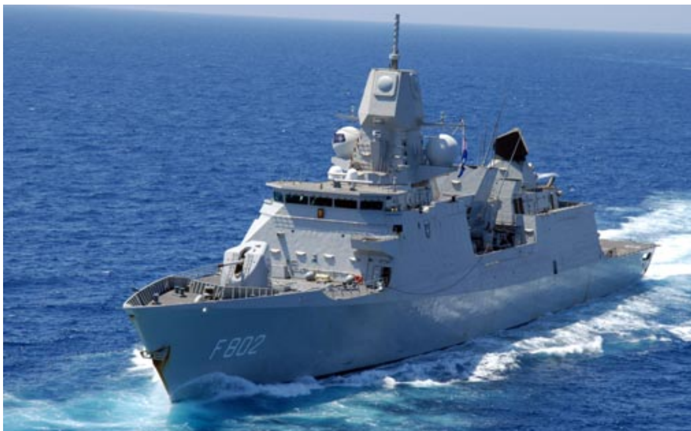
Il DE ZEVEN PROVINCIEËN , primo di 4 unità da difesa aerea equipaggiate con radar APAR e VLS per i SAM, realizzate tra 1998 e 2005 con elementi progettuali comuni con analoghe piattaforme tedesche, spagnole e danesi (US Navy).
