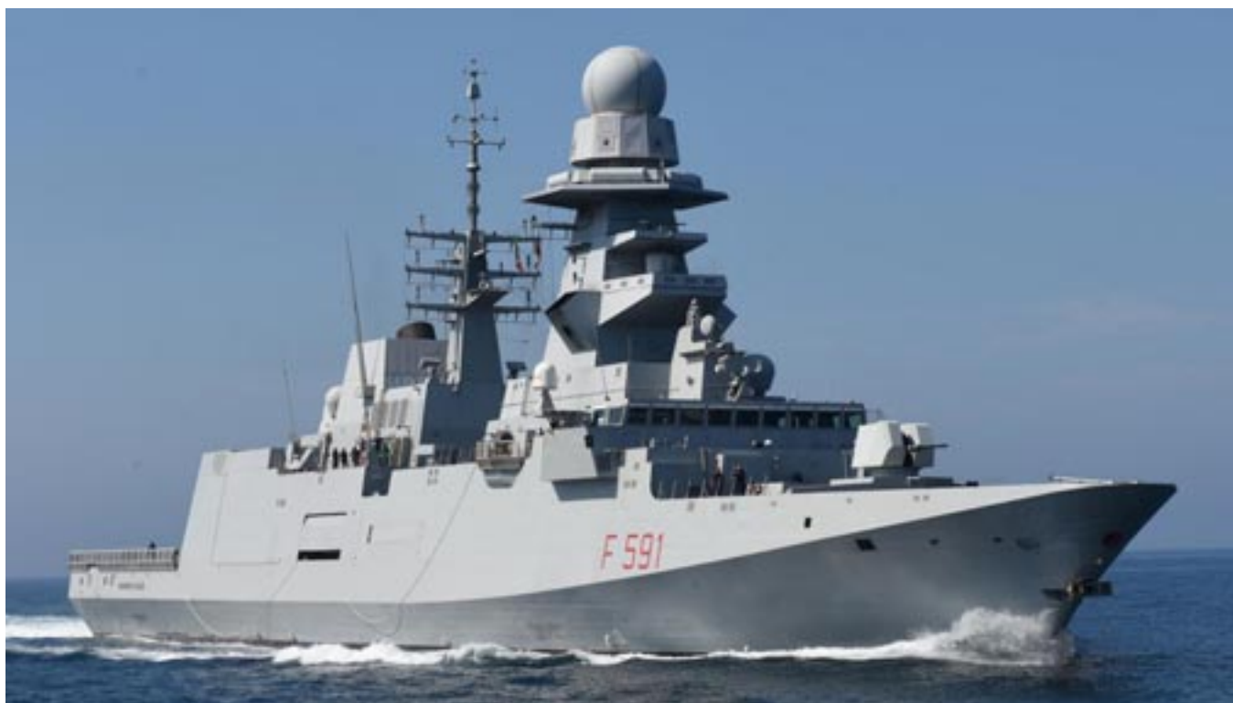
La fregata FASAN , prima FREMM italiana in versione antisom: in servizio dal 2013, è equipaggiata anche con sonar trainato CAPTAS-4, missili ASW "Milas" e un secondo cannone da 76/62 mm al posto del 127/64 "Vulcano".
