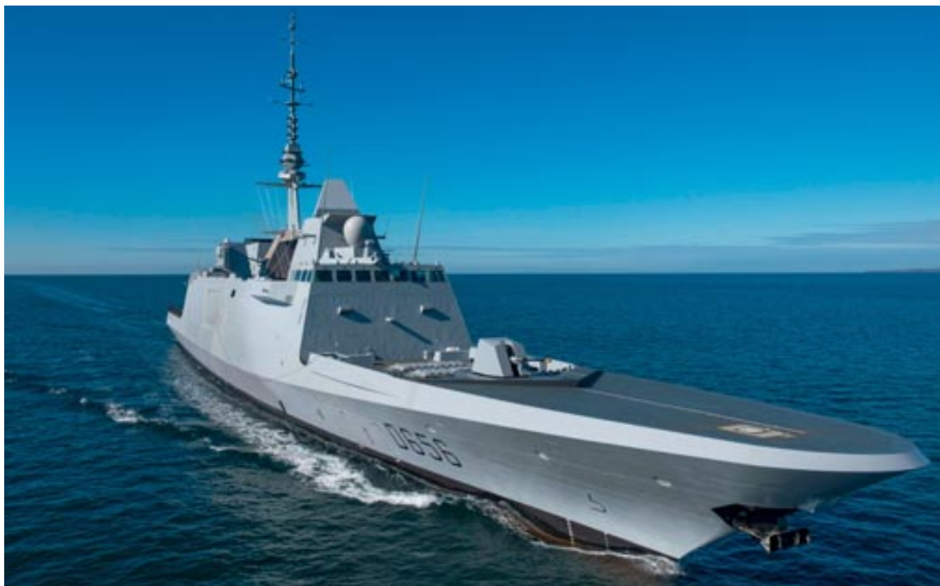
La fregata antiaerea ALSACE , una delle 2 FREMM francesi nella variante FREDa, completate nel 2021-22: sono armate come gli “Orizzonte” con VLS e missili “Aster-15/30” (Naval Group).
