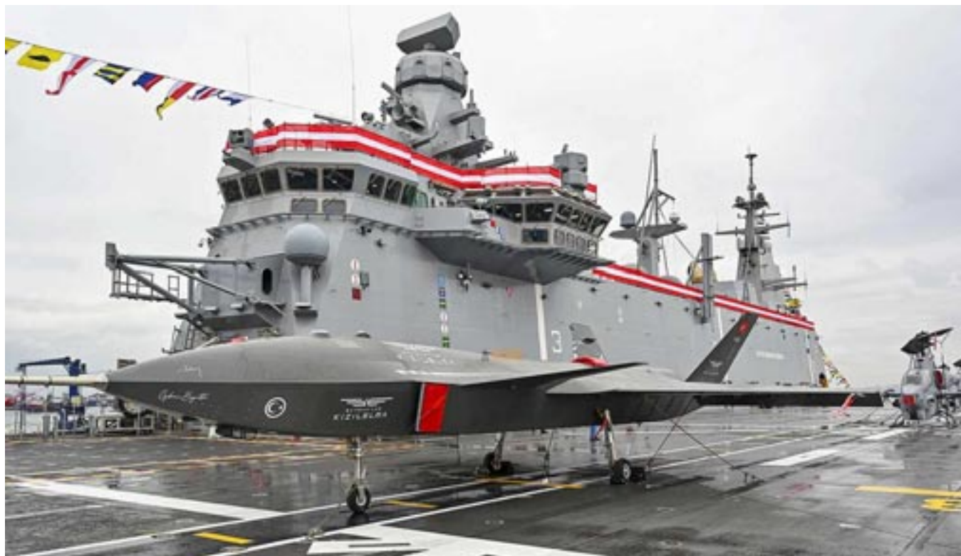
Droni d'attacco (UCAV) Baykar “Bayraktar” TB-3 e a getto “Kizilelma” sul ponte della fiammante portaeromobili anfibia turca Anadolu , costruita nel 2016-23 sulla base del progetto spagnolo del Juan Carlos I . Nata per imbarcare gli F-35B, è stata modificata in drone-carrier nel 2025, dopo la cancellazione del programma per i jet VSTOL (Turkish Navy)
