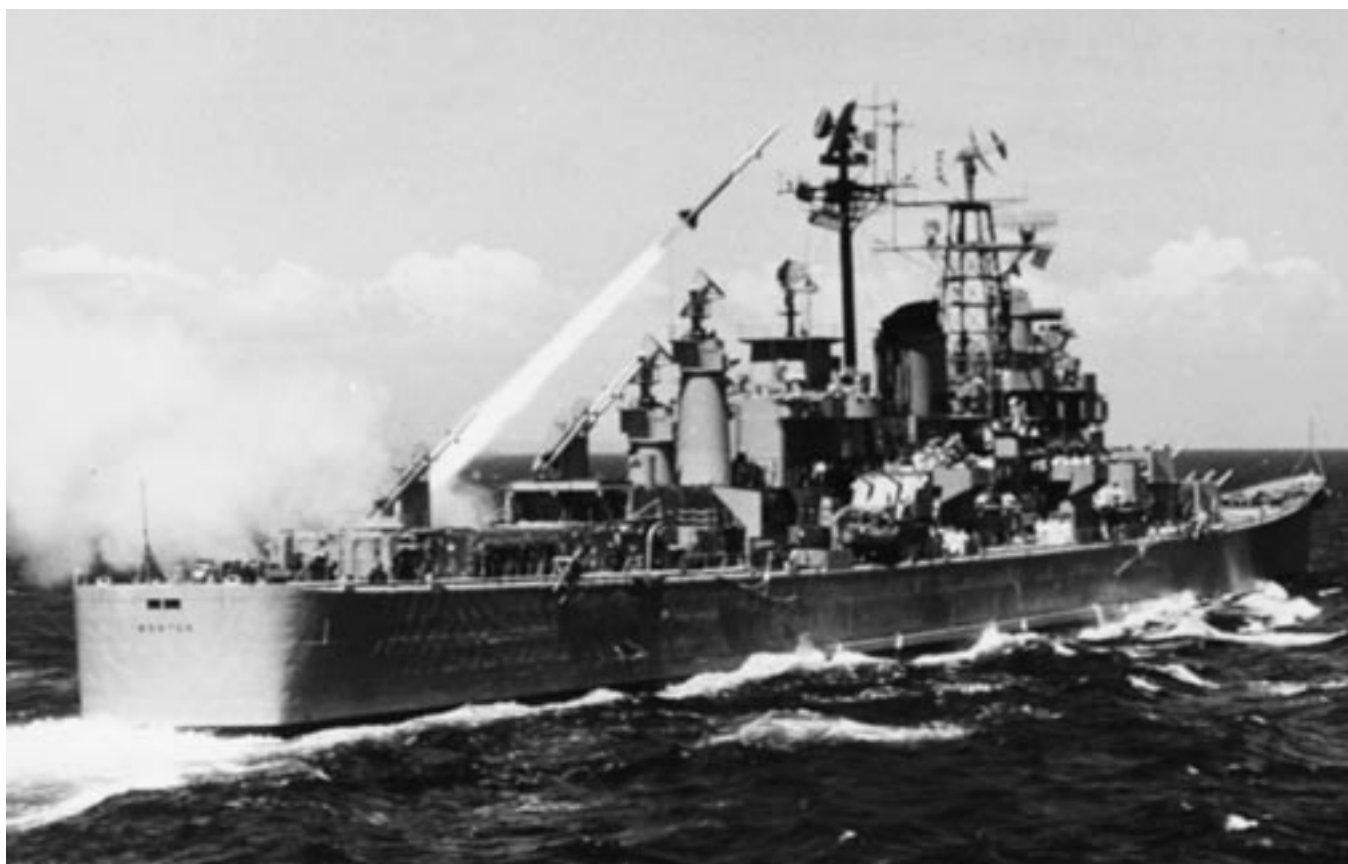
L'incrociatore americano BOSTON , costruito nel 1941-43 e prima nave a essere convertita nel 1952 in lanciamissili, mentre lancia i suoi SAM "Terrier" (US Navy).
