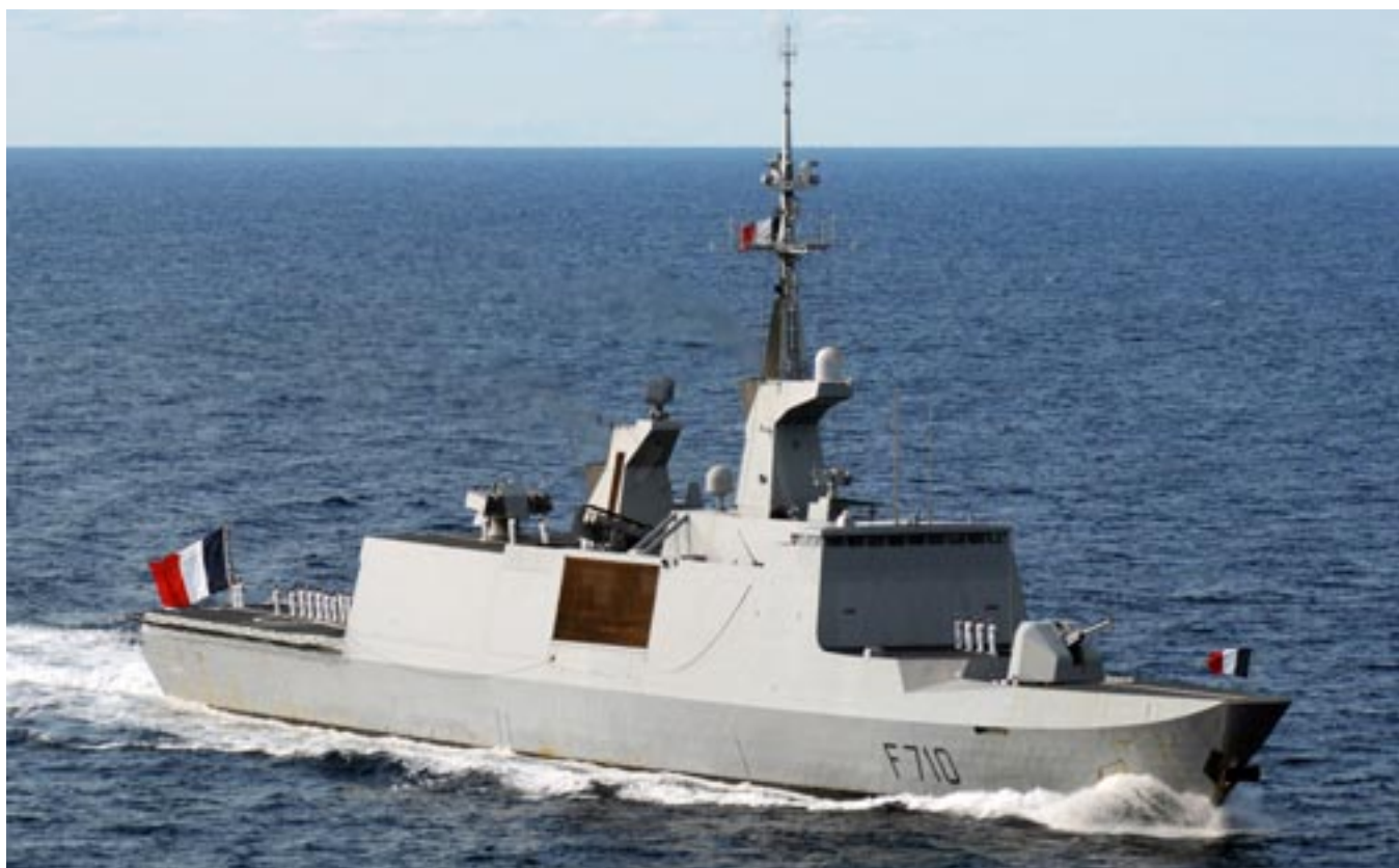
La fregata francese "La Fayette", capoclasse di 5 FFG completate tra 1995 e 2001, prime vere unità stealth, con design avanzato e materiali radar assorbenti: 3 unità sono state ammodernate nel 2020-24 (US Navy).
