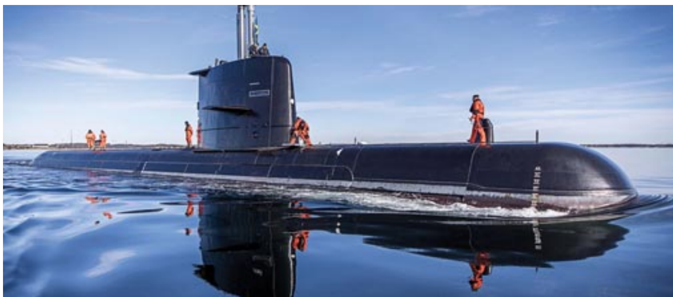
Il sottomarino svedese Gotland , capoclasse di 3 battelli costruiti nel 1992-97: i primi appositamente realizzati con il sistema AIP. Nella foto il Gotland è reduce dal radicale MLU effettuato sull'intera classe tra 2016 e 2025 (Saab/Difesa Svedese)
