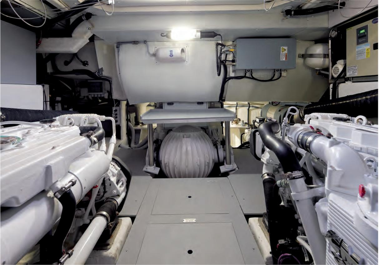
Sala macchine del Magellano 50: si vedono i due motori Cummins QSB 5.9 (ai lati) e lo stabilizzatore giroscopico (al centro). (© Azimut Yachts S.p.a.)
