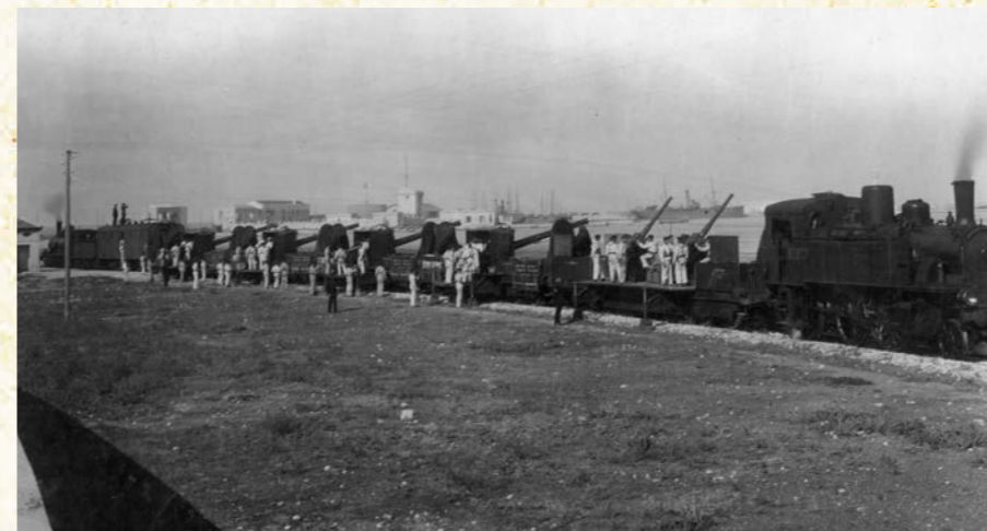
Treno armato per la difesa della costa adriatica: questi mezzi montavano artiglieria navale antiaerea e antinave ed imbarcavano equipaggi della Regia Marina.
