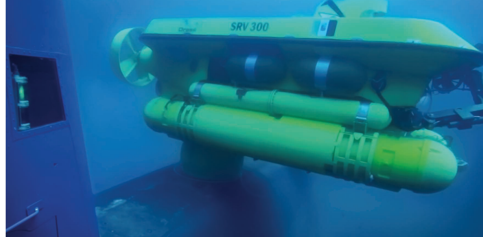
L'SRV 300 appontato sul portello di fuoriuscita del sottomarino israeliano Leviathan; in basso a sinistra: interno del minisottomarino SRV 300 dalla particolare visuale del pilota, TV Palombaro Matteo Rosso.
