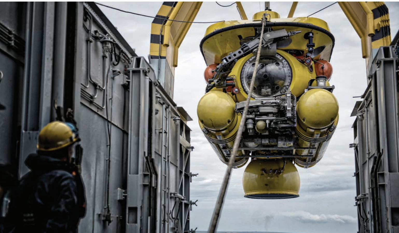
Nave Anteo, del Gruppo Navale Speciale di Comsubin; in basso: manovra di messa a mare del SRV 300 vista dall'interno del hangar di Nave Anteo. A sinistra il Nostromo dell'Unità.
