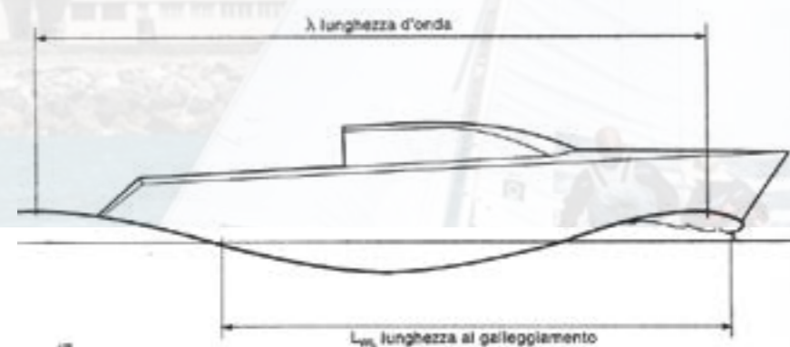
Fig. 1: la lunghezza al galleggiamento (Lwl) e l'onda che corrisponde alla massima velocità della barca.
