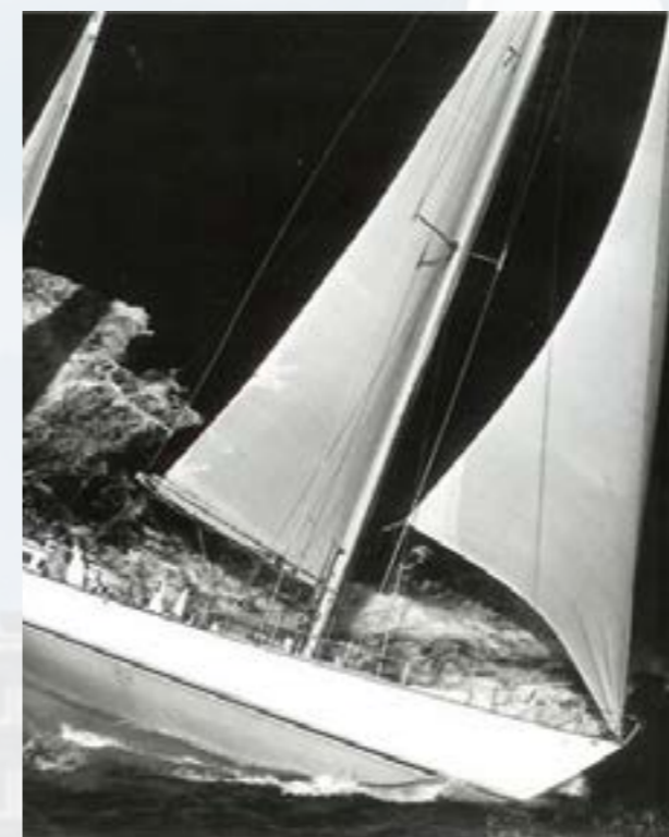
Fig. 3: scafo classico alla massima velocità per la sua lunghezza, desumibile dalla posizione dell'onda.
